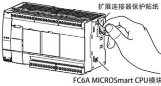
1. 揭下FC6A MICROSmart CPU模块上粘贴的扩展连接器保护贴纸。
