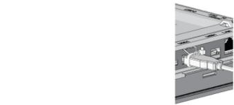
缠绕 USB 捆扎带时，与防止 USB 电缆脱落用 pin 的“捆扎部”之间应无缝隙且避免倾斜。
