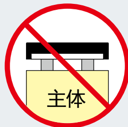
主体悬空安装
