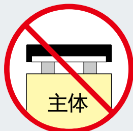
主体悬空安装
