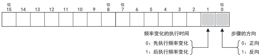
根据频率变化的执行时间设置，频率将如下图所示发生变化。先执行频率变化时，频率变化后将变为稳定脉冲，输出预置值的脉冲时，将转移到下一步骤。后执行频率变化时，以稳定脉冲持续输出脉冲后，将进行频率变化，输出预置值的脉冲时，将转移到下一步骤。
