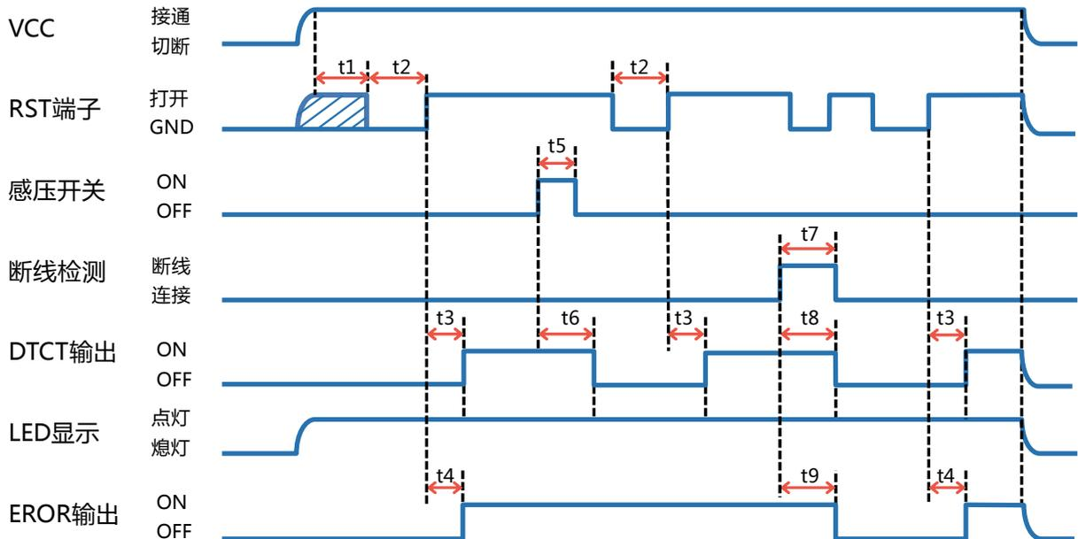
**警告** 请勿在控制设备切换至启动模式的逻辑中使用触点检测。以免因断线或控制器切断电源时，控制设备自动切换为启动模式，使其安全性降低。
