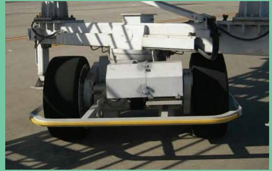
将带状感压开关与专用外护层配套组合，即可具备保护检测对象功能。
