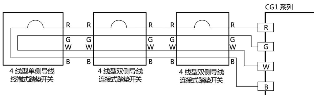
· 4线型单侧导线与4线型双侧导线踏垫开关的组合产品。
