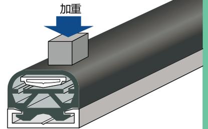
使用10×10mm的测头，垂直在外护层表面加重，测量开关ON时的负荷值。
