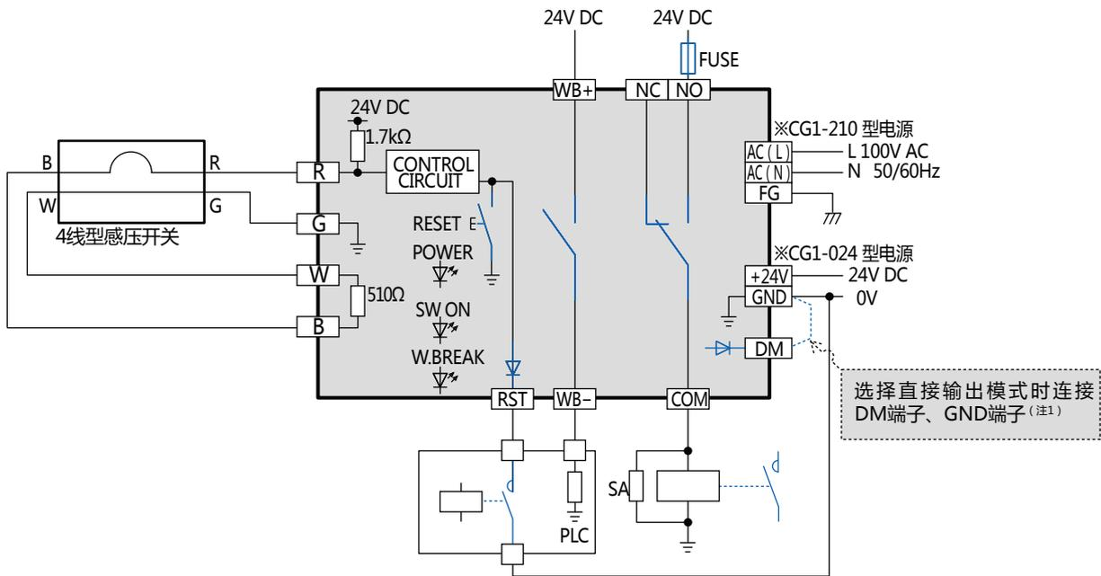
注1：检测到开关ON之后，若返回到初始状态时，需省略复位操作，请设置为“直接输出模式”。
