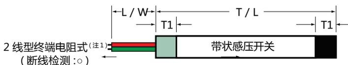
注 1: 2 线型终端电阻式带状感压开关外护层的终端部为黑色。
