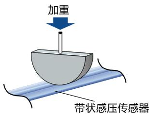
使用φ32×10mm的测头，将其垂直压置于带状感压传感器中部。采用降压法(IEC61020-1)的试验电路，通过电极间接触测量10mA电流流过时的负荷值。
