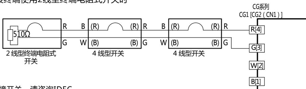
※2线型终端电阻式碰撞开关, 请咨询IDEC.
