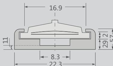
凸缘突出于凹槽外框的高度 (mm)
