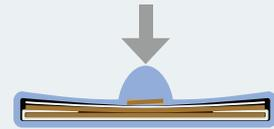
按压带状感压开关中央部的凸缘，因上层电极板被凸缘传递的负载压下与下层电极板接触，接通电路。
