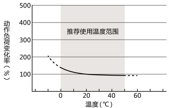
环境温度下降时，因外护层材料(PVC)硬化灵敏度会降低。
