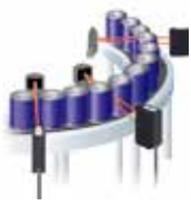
在高速生產線上，物體和物體之間的狹窄縫隙的檢測
