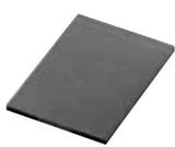
色板 | 丙烯酸樹脂 | MC3D 型 | 全面照光用<br>17H×24.8W×1t mm                           | MC9Z-PA3*    | 1 片        | 請指定下列顏色記號替換型號中的*。<br>R : 紅色<br>GD : 綠色 (LED 燈泡用)<br>GL : 綠色 (白熾燈泡用)<br>A : 琥珀色<br>C : 透明 (註)<br>Y : 黃色<br>S : 藍色<br>• 材質：丙烯酸樹脂。<br>• 套裝內容請參閱 458 頁。<br><br>註：PW (純白色) 照光時用。 |
