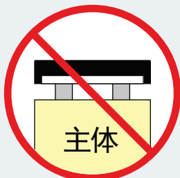
主体悬空安装
