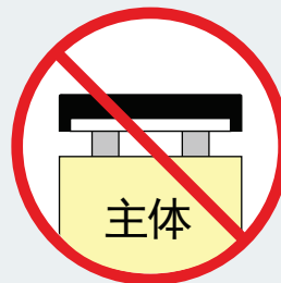
主体悬空安装
