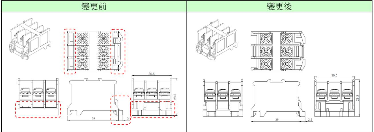
◇變更部分形狀及端子金屬零件厚度
