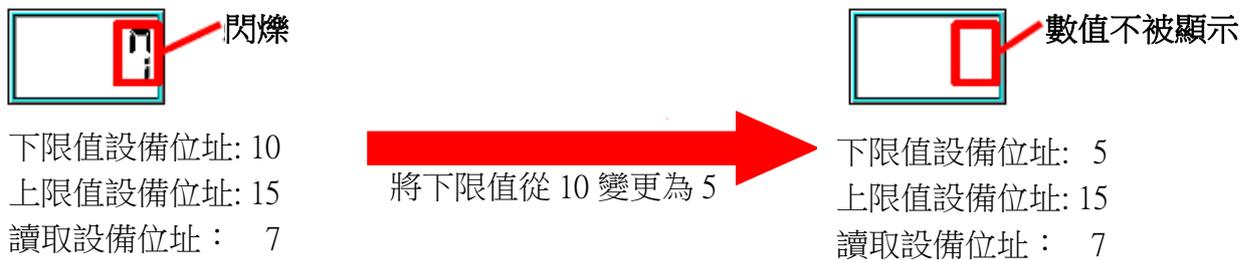
圖 6-1 數字顯示器的顯示狀態
