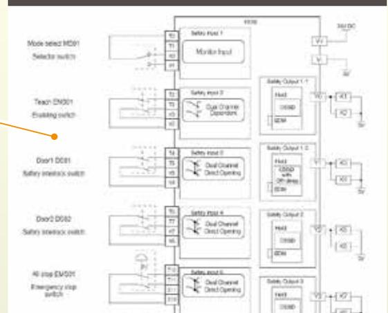
可以显示客户为模拟逻辑配置的输入设备接线范例。(显示选择的输入设备的接线) 可用于向认证机构报告或公司内部管理。
