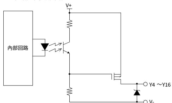
□ 電磁線圈 / 指示燈輸出規格
